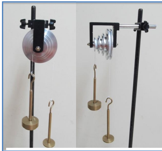
Figura 1: Montaje de polea de cuatro pasos.
