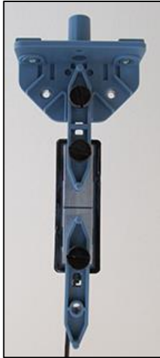
Figura 2: Montaje celda de carga y soporte para masa.
