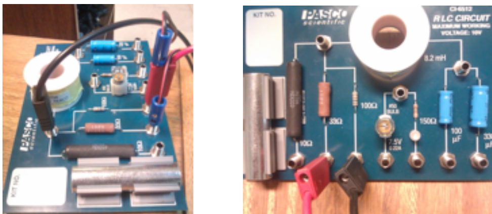
Figura 3: Resistencias de 33\ \Omega y 100\ \Omega conectadas en paralelo (izquierda) y en serie (derecha). Para la conexión en paralelo utilizar un cable extra entre los terminales de ambas resistencias (cable de conectores redondos).
