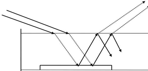
**Figura 1:** Refracción en una superficie de agua. Los rayos que entran al agua se refractan hacia la normal
