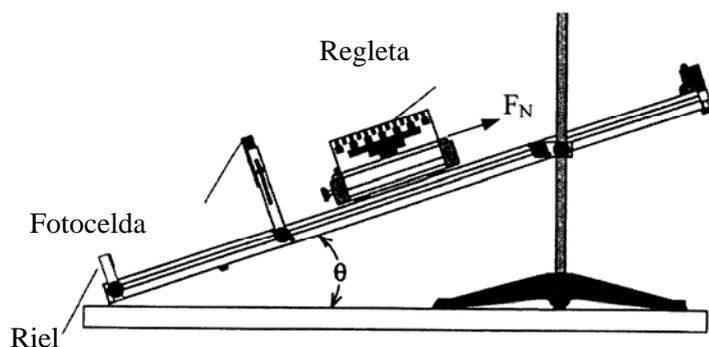
**Figura 2 :** Montaje del carro dinámico con el dinamómetro
