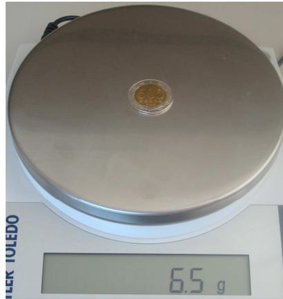
Figura 3.2: El lector de la balanza digital nos muestra una medición para el peso de una moneda de quinientos pesos. El error de lectura asociado deberá ser la mitad del valor de la última potencia de diez desplegada, es decir, 0.05 g.
