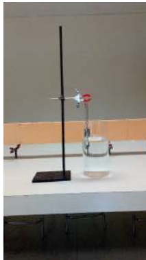
Figura 2: Montaje para movimiento oscilatorio con amortiguación débil
