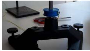
Figura 3: Eje con polea (en azul) para determinar I_{\perp}
