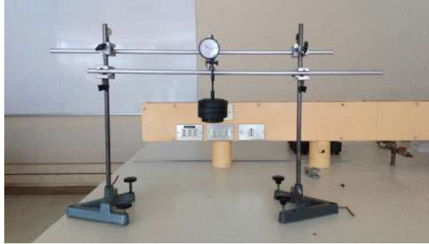
Figura 3: Montaje para la estimación del módulo de elasticidad
