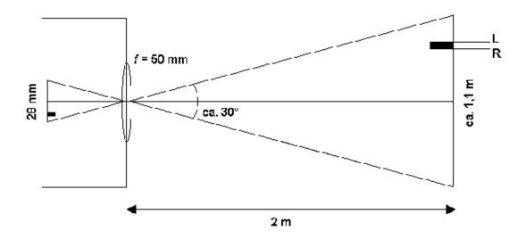
El tiempo de exposición se opera con una cortina con velocidad 1/800 s. Para una velocidad típica de 1 m/s esto corresponde a un desplazamiento de 1.25 mm durante el tiempo de exposición. Sin embrago, la pérdida de resolución es la misma a ambos lados del objeto, de modo que el error en el punto medio es menor.
